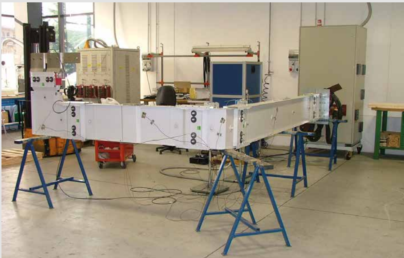
Сертификационные испытания шинопровода серии SCP в лаборатории Zucchini
